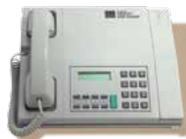
Le système voix/fax CSD 3324 SP utilise le chiffrement AES-256 et une clé publique.
